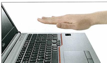
**Bild 2:** Die biometrische Authentifizierungstechnologie PalmSecure von Fujitsu scannt die Venen der Handfläche. Das Erkennen der Venen erfolgt mithilfe von Infrarot-Licht, ohne dass das Gerät berührt werden muss. Bild: Fujitsu
